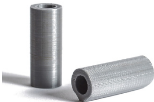
Dos cilindres idèntics impresos a la mateixa alçada de capa en diferents orientacions.
